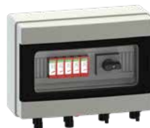
MSB-222-32-1000-MDM-BC 2 MPPT / 2 Eingang / 2 Ausgang / MC4-EVO 1005 VDC / 32A max / Eingang/Ausgang
