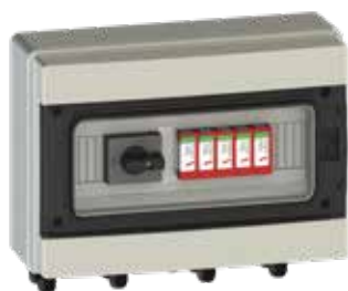
MSB-222-32-1000-CDC-BC 2 MPPT / 2 Eingang / 2 Ausgang 1005 VDC / 32A max / Eingang/Ausgang
