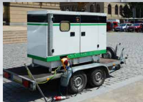
Diesलगенератор für Notstrom Diesel generator for emergency power
