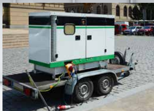
Generador de emergencia diésel Diesel generator for emergency power
